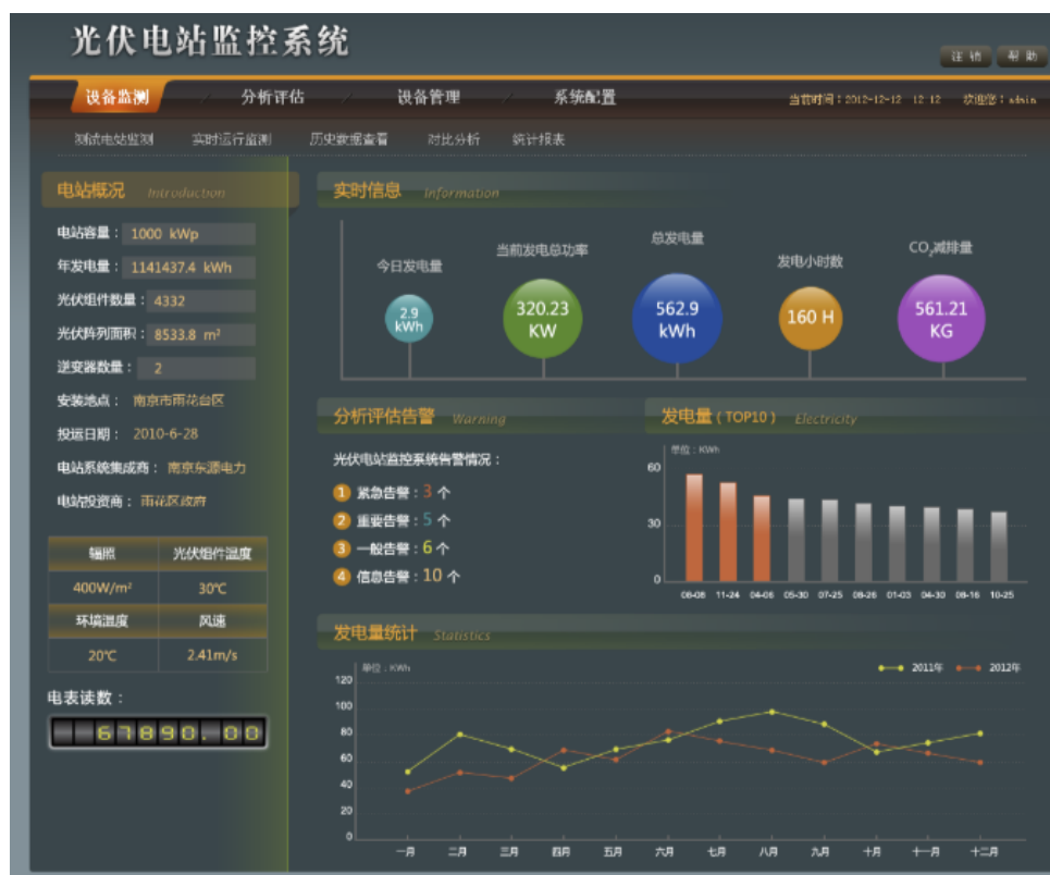
光伏电站监控系统示意图
